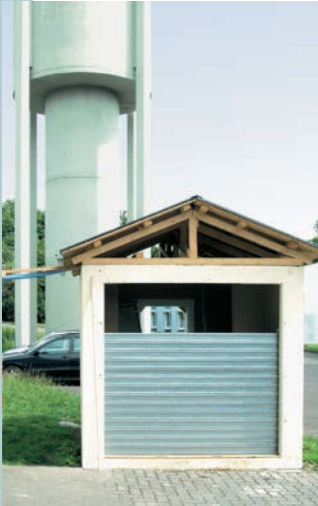
Hochwasserversuch mit dem WP WASTO System bei der FWU, Forschungsstelle Wasserwirtschaft und Umwelt der Universität Siegen: Praktischer Versuch, Abdichtbreite 2000 mm, Stauhöhe 1700 mm
